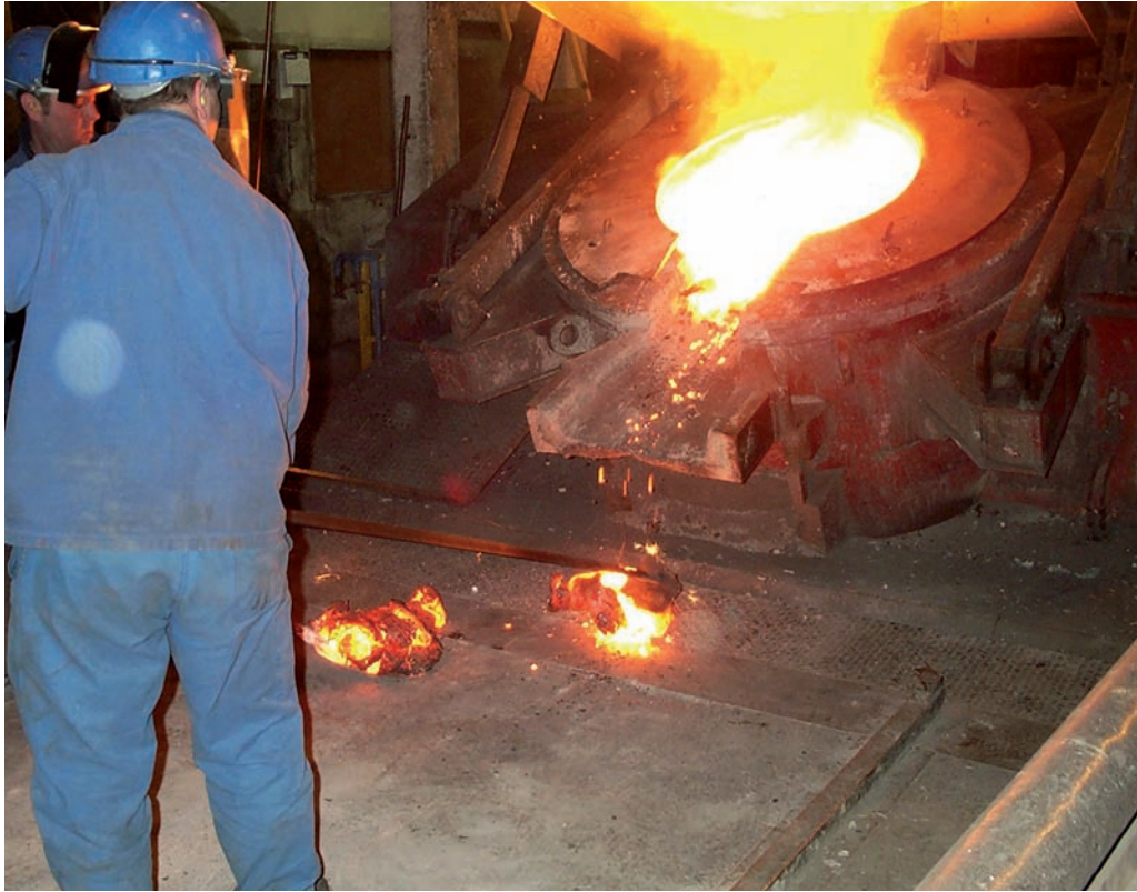
Béton d'aluminates de calcium pour résister aux chocs thermiques et températures élevées du métal en fusion.
