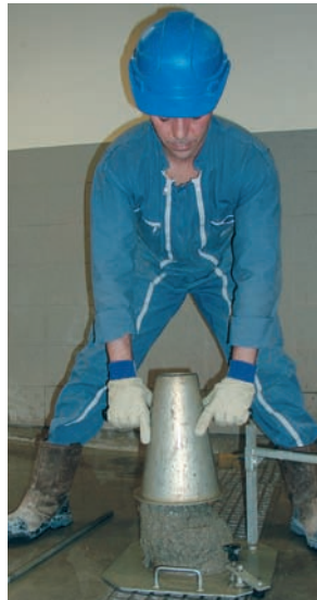
Contrôle de la plasticité : affaissement au cône d'Abram
