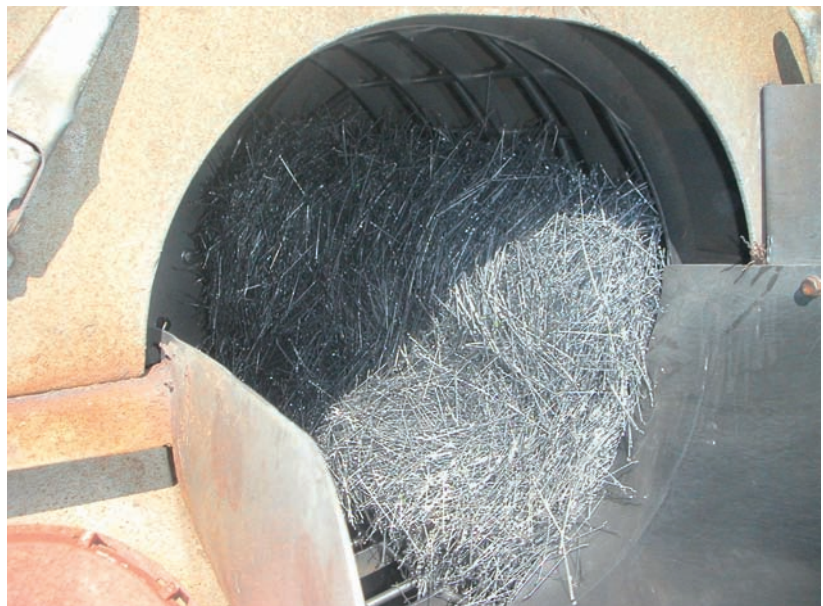
Introduction des fibres métalliques dans le malaxeur.
